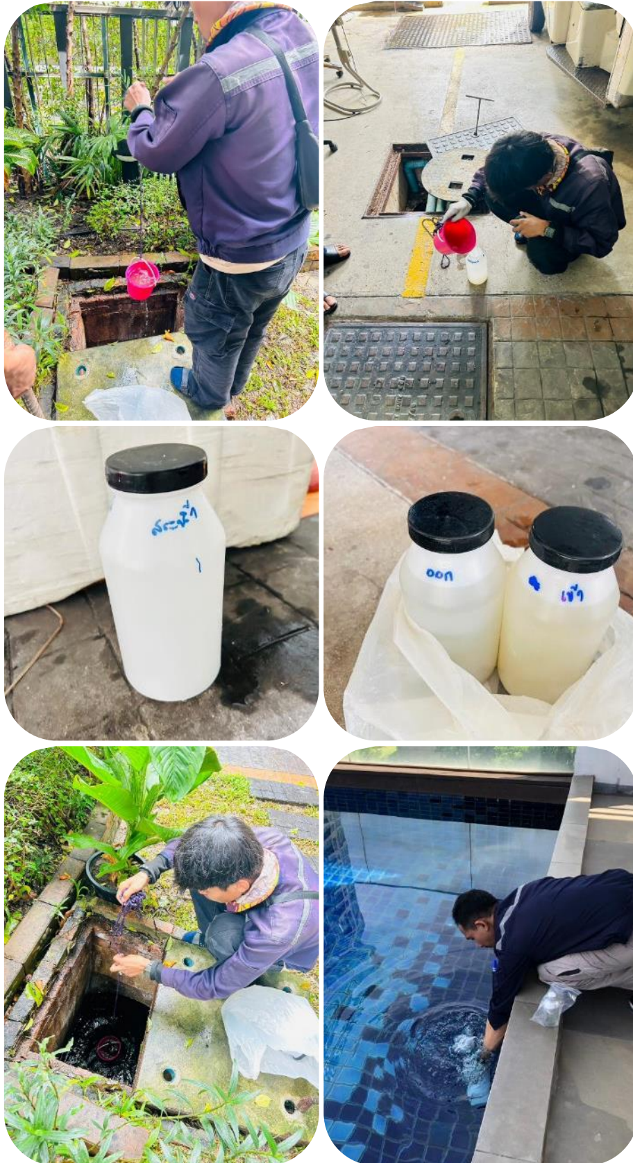
ภาพที่ 3.2-1(1) เก็บตัวอย่างน้ำบ่อบำบัดโครงการส่งตรวจสอบ
